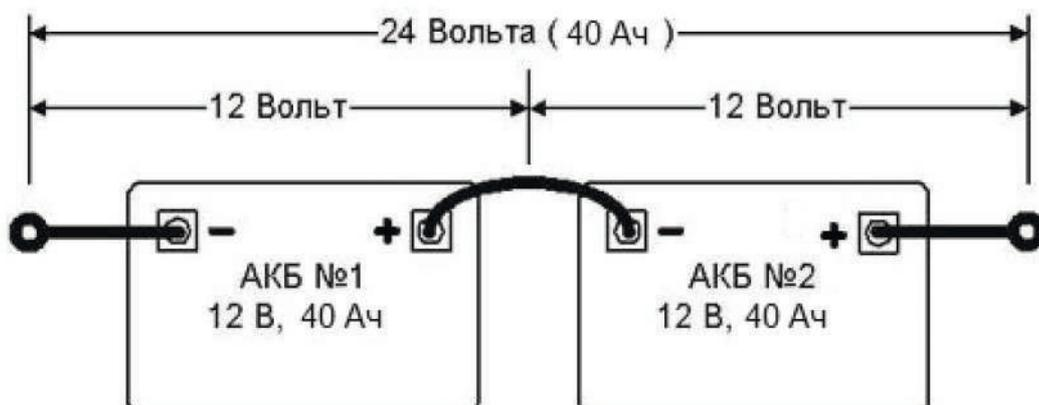
Для увеличения выходного напряжения АКБ подключают последовательно. Следует использовать изделия одинаковой ёмкости, модели и степени износа.
