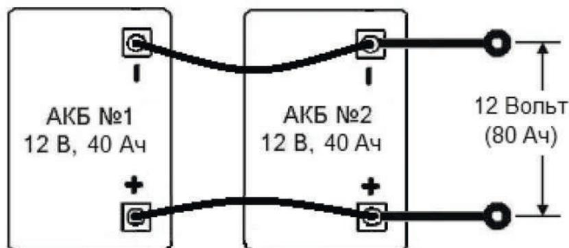
Для увеличения ёмкости АКБ подключают параллельно. При этом АКБ обязательно должны быть одного уровня заряда и одного напряжения (см. рисунок выше). Сопротивление кабелей каждого соединения должно быть одинаково, - для чего используйте кабели одинаковой длины и сечения.
